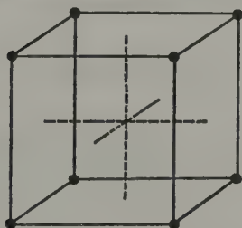
Fig. 9-4. Simple cubic lattice
